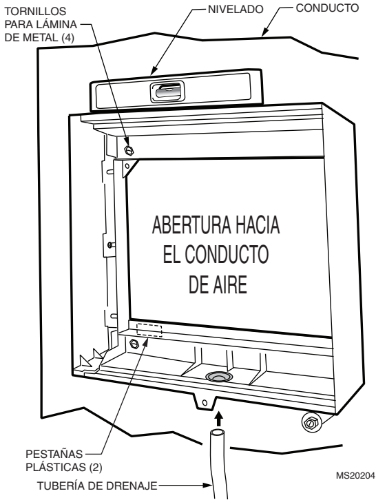
Fig. 5. Instalación del humidificador en un conducto.
